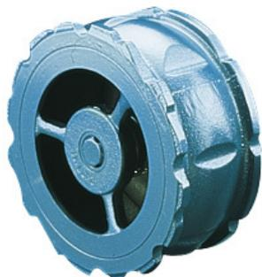
Pression PFA/PS en bar. Température maxi : 200°C / 65 à 200 mm : 100°C. Corps : DN 32 à 50 : laiton DZR / DN 65 à 100 : fonte GJL revêtue époxy ext. / DN 125 à 200 : fonte GJLS revêtue époxy ext.. Obturateur : acier inoxydable (316L) / DN 125 à 200 : ensemble d'obturation tout fonte. Guide : acier austénitique. Ressort : acier austénitique.
