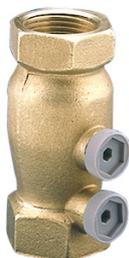
Clapet pression PFA/PS en bar - Température maxi :80°C - Corps : laiton (DN 2 en bronze) - 2 bossage taraudés 1/4, bouchons POM (polyacétal) + joint EPDM - Guide : PPO (polyacétal) - Obturateur : POM (polyacétal) ou PA - Joint à lèvres NBR (nitrile) - Ressort : acier inox.
