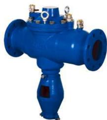
Pression PFA 10 bar 65°. Disconnecteur à zone de pression réduite contrôlable avec entonnoir incorporé - montage horizontal. Corps : fonte revêtu époxy. Clapets : PPO (polyphénylène oxyde) ou bronze. Joints : EPDM. Ressort : inox.
