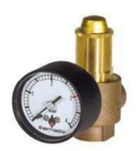
Corps bronze. Joint & membrane EPDM. Ressort inox UNI 3823. Pression nominale PN10. Températures 5 / 110°C.
