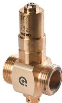
Corps laiton, MM 1"1/4 L'élément thermostatique ouvre la cartouche dès que la température de l'eau est inférieure à 4°C. La soupape anti vide incorporée permet l'entrée d'air.
