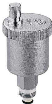
Corps laiton matricé chromé. Pointeau d'évacuation en inox. Ressort inox. Pression maxi : 10 bar. Pression de fonctionnement 2,5 bar. Température maxi 110°C.
