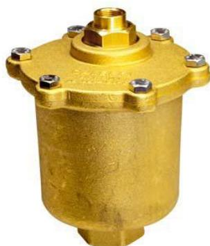
Corps et couvercle laiton. Poinreau d'évacuation, filtre anti impuretés et ressort inox. Joints EPDM. Flotteur inox. Pression maxi : 16 bar. Pression de fonctionnement 6 bar. Température maxi 120°C.
