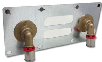
Ce kit est dédié à l'installation de robinetterie sur un support en plaque de plâtre. Il permet de réaliser un raccordement solide et fiable entre le tube (PER ou Multicouches) et le robinet (ou mitigeur). Composition du KIT : 1 platine inox avec brides et vis prémontées, 2 coudes laiton avec raccords, 2 bouchons plastiques 15/21 avec joint prémontés, 9 chevilles 4x46 corps creux + vis.
