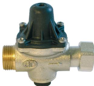
Le réducteur de pression SECURO possède un raccordement en entrée mâle et sortie avec écrou tournant. Testé en réglage 1 à 5,5 bar, le réducteur est pré-réglé à 3 bar. Les fluides admis sont l'eau, l'air et les gaz neutres. Conforme aux normes ACS. Pression : 16 bar. Diamètre nominal : 20 mm.
