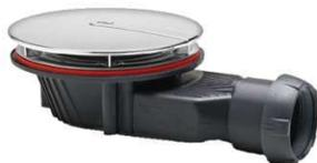
Dôme ABS Chromé Ø 118 mm -&nbsp;b Cartouche (PP) et membrane (silicone) c Filtre à cheveux (PP) d Vis (acier inoxydable) e Plateau (acier inoxydable) f Insert (laiton) g Joint bi-injecté h Corps (ABS) Joint (PEHD) Ecrou (PP)
