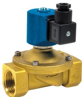
Electrovanne normalement fermée. Noyau et pièces internes en acier inoxydable. Protection électrique IP65. Ps Fluide 0-10 bars. Pas de différentiel pression. Fluide : -5°C- +80°C. Alimentation 220 V.
