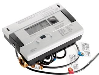
Compteur d'énergie thermique compact à ultrasons. Approbation selon EN 1434 et MID en classe 2 avec une dynamique de mesure de 1:250. Gamme complète du DN 15 mm qp 1,5 m<sup>3</sup>/h au DN 100 mm qp 60 m<sup>3</sup>/h. Alimentation pile longue durée 16 ans (en utilisation standard) Option Radio intégrée.
