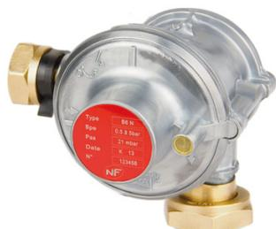
Réduction de la pression de la colonne montante moyenne pression (5 bar) à la pression de distribution : 21 ou 27 mbar pour le Gaz Naturel et 37 mbar pour le Gaz Propane réseau. Pression d'entrée : 0,5 à 5 bar. Pression de sortie : 21, 27 ou 37 mbar. Entrée écrou prisonnier tournant femelle à Jonction Sphéro-Conique. Sortie écrou prisonnier tournant femelle à Joint Plat Compteur.
