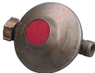
Pression amont maxi : 20 bars. Pression aval : 37 mbars. Entrée écrou 20x150 - Sortie Mâle 20x150.
