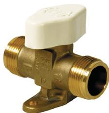
Conforme aux normes NF XP M88-771. Débit 4 kg/h à 37 mbar. Débit 40 kg/h à 1.5 bar. Débit 80 kg/h à 4 bar. Entrée et sortie mâle G 3/4. Livré avec 2 raccords à braser F20x27- CU18.
