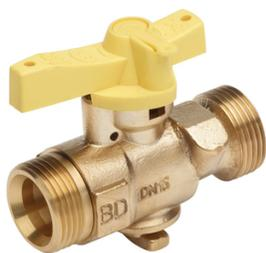
Pression maximale d'utilisation : 5 bar. Version double mâle à Jonctions Sphéro-Coniques. Version à entrée PE à serrage mécanique et sortie mâle à Jonction Sphéro-Conique. Classe de température : - 20°C / + 60°C. Certifié NF ROB GAZ. Conforme NF EN 331.
