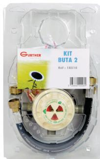
Comprend : 1 détendeur inverseur automatique 2.6 kg/h 28 mbar - 2 Lyres souple longueur 35 cm - 1 sachet de raccords Ø 12 - Presssion amont bouteille maxi 8 bar - Presssion aval 28 mbar
