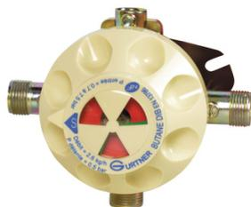
Conforme aux normes NF M 88 770. Débit 2,6 kg/h. Pression amont bouteille maxi 8 bar. Pression aval 500 mbar. Entrée mâle 20/150. Sortie mâle 20/150.
