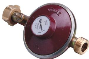
Conforme aux normes NF EN 12864 et XP M88-778. Débit 1.3 kg/h. Pression amont bouteille maxi 8 bar. Pression aval 28 mbar. Entrée écrou bouteille. Sortie mâle 20/150 Avec système de déclenchement en cas de rupture d'un tuyau.
