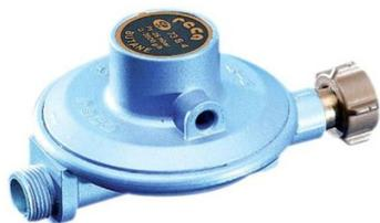
Conforme aux normes NF M 88 765. Débit 2,6 kg/h. Pression amont bouteille maxi 8 bar. Pression aval 28 mbar Entrée écrou bouteille. Sortie mâle à souder 12.
