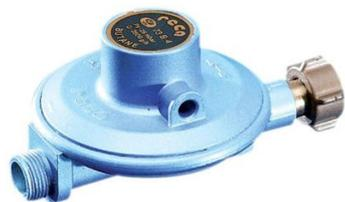
Conforme aux normes NF M 88 765. Débit 2,6 kg/h. Pression amont bouteille maxi 8 bar. Pression aval 28 mbar. Entrée écrou bouteille. Sortie mâle 20x150.
