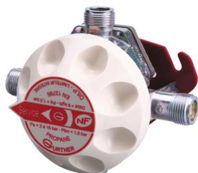
Conforme aux normes NF EN 13786 et XP M88-779. Débit 6 kg/h. Pression amont 1ère détente 1,5 b ou bouteille maxi 20 bar. Pression aval 1,5 bar. Entrée mâle 20x150. Sortie mâle 20x150.
