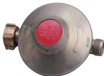
Débit : 2 Kg/h. Pression amont maxi : 20 bars. Pression avale : 37 mbars. Entrée écrou bouteille. Sortie Mâle 20x150.
