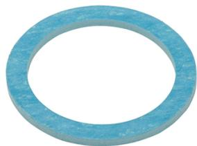
Joint plat gaz (JPG) dur en aramide, à installer entre un raccord à filetage mâle et un raccord à filetage femelle à JPG, permettant d'assurer l'étanchéité. Certification? : Conforme à la norme NF E29-533. Pression maximale d'utilisation : 500 mbar. Joint dur en fibre synthétique (aramide) livré systématiquement avec nos raccords à JPG. Classe de température : de -20°C à +60°C.
