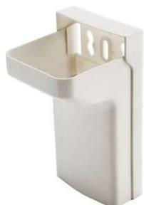
Permet de cacher la robinetterie des radiateurs verticaux lorsqu'un raccordement central est réalisé. Finition esthétique. Protège les tubes des chocs. Clipsable et démontable sans fixation apparente. S'adapte à la plupart des radiateurs de type 20, 21, 22. Epaisseur au pied 45 mm. Epaisseur sous le radiateur 100 mm.
