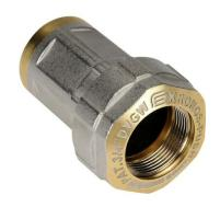
Raccord de réparation rapide laiton pour tube fer. Raccordement à serrage extérieur. Raccord union femelle. Utilisation : Eau, eau potable, chauffage, gaz. Le système d?étanchéité à joints coniques (NBR) permet de compenser tout éventuel sous-dimensionnement du diamètre du tube. Le collier anti-déboîtement en laiton adhère parfaitement au tube grâce à une indentation autobloquante. Garantie 5 ans.
