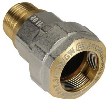
Raccord de réparation rapide laiton pour tube fer. Raccordement à serrage extérieur. Raccord union mâle. Utilisation : Eau, eau potable, chauffage, gaz. Le collier anti-déboîtement en laiton adhère parfaitement au tube grâce à une indentation autobloquante. Garantie 5 ans.
