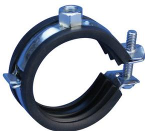
Collier une vis avec connecteur M8. Isolant caoutchouc, tête à vis cylindrique M6 avec formes combinées pour tous les tournevis. Pour tube de diamètre extérieurs de 12 à 61 mm
