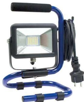
Longévité accrue grâce aux LED hautes performances SAMSUNG : >50000 heures ? Support pivotant et écran en verre remplaçable ? Cordon 2 m H05RN-F 3G1,0 ? Angle du faisceau 120° ? Alimentation : 230 V / 50-60 Hz ? Poids : 1,2 kg ? Conformité : DIN EN 60598-1 ? IP65 : Etanche à la poussière et protégé contre les jets d'eau
