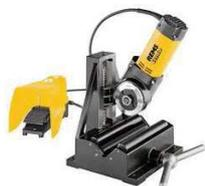
Machine compacte, légère, mobile. Universelle pour couper et ébavurer les tubes sur chantier ou en atelier. Tuyaux d'écoulement/tuyaux de descente soudés en acier inoxydable. Pour couper : Tubes acier, cuivre Ø 8 ? 108 mm, Tubes fonte DN 50 ? 100, Tubes plastique épaisseur de paroi ?, 10 mm Ø 10 ? 110 mm, Tubes multicouche Ø 10 ? 110 mm
