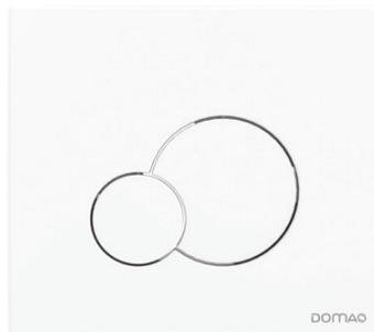
Plaque en ABS. Double volume. Actionnement mécanique. Effort d'actionnement inférieur à 20 Newton. Sert de trappe de visite pour accéder à l'équipement du réservoir.
