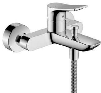
2 fonctions. Projection : 182 mm. Distance du centre : 150 mm  $\pm$  12 mm. Type de jet du mitigeur : jet normal. Débit maximal à 3 bars : 20,9 l/min. Débit du bec de baignoire à 3 bars : 20,9 l/min. Débit de la douchette à 3 bars : 17,3 l/min. Cartouche céramique. Limiteur de température réglable. Inverseur avec réinitialisation automatique. Avec combinaison de sécurité intégrée EN 1717. Avec silencieux. Convient au chauffe-eau instantané. Type de raccordement : raccords S. Montage mural.
