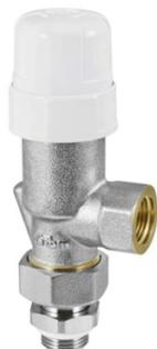
Robinet pouvant recevoir une tête thermostatique RBM TL10 ou TL20 - pour chauffage eau chaude. Type : équerre inversé. Convient aux radiateurs fonte, acier et aluminium. Douille radiateur : M 3/8" ou 1/2" (selon version). Raccord entrée : M 24,5 x 19.
