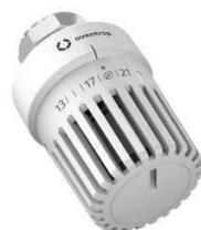
Repère vert indicatif pour la position 19 °C. Valeur de consigne maximale limitée en usine à 21 °C. Plage de réglage : possibilité de limiter, bloquer ou étendre jusqu'à max 28 °C. Pastille mémoire permettant de mémoriser la température désirée. Réglage 20 °C peut être facilement retrouvé à l'aide des dispositifs de réglage palpables.
