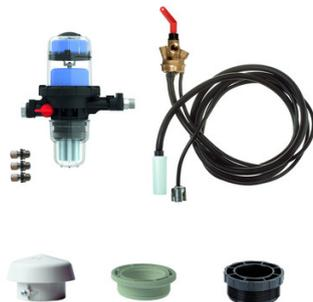
Le Colifioul contient tous les composants pour réaliser la liaison entre le brûleur et le réservoir (polyéthylène, plastique ou acier). Livré avec un flotteur pour prélever le fioul au-dessus des boues de fond de cuves (empêche les pannes dues aux impuretés). Tamis synthétique, filtration à 50 microns. Étanchéité absolue grâce aux bagues et raccords en laiton utilisés sur le filtre et le combiné. Emballage informatif pour le libreservice et le stockage.
