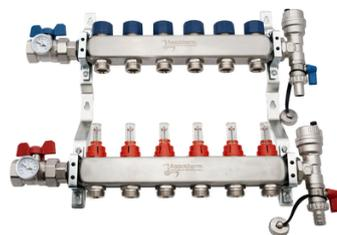
Composé de : 1 collecteur retour en acier inoxydable AISI 304L avec vannes d'arrêt prédisposées pour commande électrothermique, 1 collecteur départ en acier inoxydable AISI 304L avec débitmètres, 2 étriers métalliques complets, 2 vannes à boisseau sphérique d'arrêt avec thermomètre, 2 groupes terminaux avec vanne d'évacuation de l'air et robinet de vidange.
