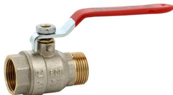
Passage intégral. Presse étoupe en PTFE (120°C). Laiton titré conforme Norme Européenne EN12165. Manette plate. Traçabilité (logo-date de fabrication). ACS et conforme 4MS.
