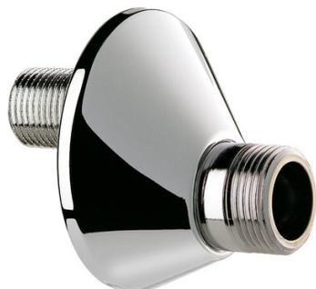
Raccord décalé universel de 21 mm (modèle déposé). Pour les robinetteries d'entraxe 110 à 190 mm. M3/8" - M3/4". Rosace en ABS Ø 70. L.63 mm. Laiton massif. Livré par 2 pièces. Garantie 10 ans.
