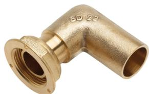
Pression maximale d'utilisation : 500 mbar. Écrou prisonnier tournant femelle plombable et douille à Joint Plat Compteur à braser sur tube cuivre ou sortie acier. Livré avec 1 joint.
