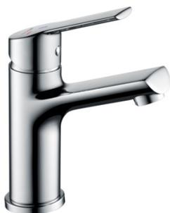
Fabrication Française. Cartouche 35 mm C3. Economie d'eau et économie d'énergie. Vidage ABS NF clic-clac. Basette métal Ø 43 mm. Aérateur anti-calcaire. Hauteur totale 168 mm. Hauteur sous bec 98 mm. NF E1 C3 A2 U3 (code usine MPL17).
