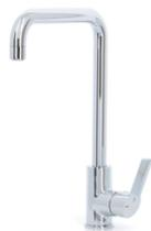
Fabrication Française. Cartouche 35 mm C3. Economie d'eau et économie d'énergie. Basette métal Ø53 mm. Aérateur anti-calcaire. Hauteur totale 354 mm. Hauteur sous bec 281 mm.
