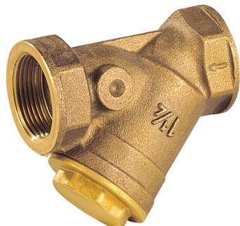
Filtre à tamis bronze pour les réseaux d'adduction et de distribution d'eau, fluides non corrosifs et air comprimé. Filtration fine 300 type gaz avec tamis en inox 304. L'étanchéité est assurée par un joint PTFE. Compatible avec les réseaux d'eau potable grâce à l'attestation de conformité sanitaire (ACS).
