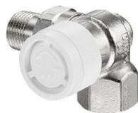
Robinet thermostatique Série AV 9, robinet d'angle, raccordement à droite. Laiton nickelé. kvs: 0.9. Pression différentielle max.: 1 bar. Pression de service max.: 10 bar. Température de service max.: 120 ° C.
