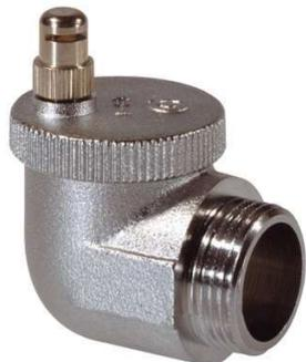
Laiton matricé, nickelé. Filtre de protection contre les impuretés. Pression maxi de fonctionnement 10 bar. Pression maxi de décharge 6 bar. Température maxi 100°C. Pourcentage maxi de glycol 30%.
