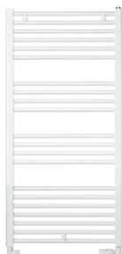
Radiateur sèche-serviettes en acier. Fonctionne sur le circuit de chauffage central. Finitions: couche primaire par électrophorèse et revêtement de finition en poudre époxy-polyester. Fixations : 3 fixations indépendantes du radiateur. Raccordement : 2 orifices en bout Ø 15/21 et purgeur d'air à jet orientable Ø 15/21 mm. Pression de service maximum : 8 bar. Type CM (raccord central).
