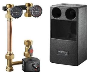
Système Regumat pour le raccordement de la chaudière à la tuyauterie. Raccordement filetage mâle G 1½ à joint plat. Sans circulateur, avec robinet d'isolement à tournant sphérique et isolation universelle.
