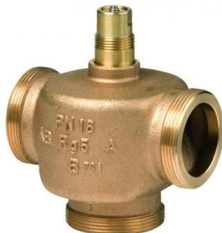
Corps en bronze CC491K (Rg5). DN 15?DN 40. kvs 0,25?25 m<sup>3</sup>/h. Raccords auto-étanches à joint plat G?B selon ISO 228-1. Lots de raccords à vis filetés ALG., disponibles chez Siemens. Réglage manuel par bouton rotatif intégré. Utilisables avec les servomoteurs électriques SQS?
