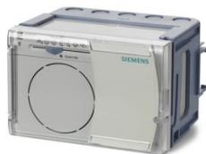
Régulation de la température de départ en fonction de la température extérieure, avec ou sans compensation de la température ambiante. Action progressive sur vanne avec moteur points ou thermique ou sur brûleur tout ou rien. Pente de chauffe réglable. Modèle RVP 211 : avec production d'eau chaude sanitaire. Avec boucle de régulation ECS soit par pompe de charge, soit par la vanne mélangeuse (prévoir sonde QPA21.3). Vendu sans l'horloge analogique.
