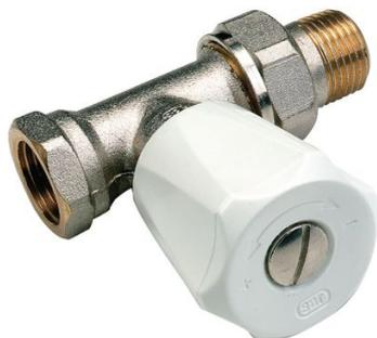
Robinet manuel double réglage. Débit qui se règle grâce à la clé COMAP 135. Permet d'avoir une fonction d'équilibrage supplémentaire par limitation du clapet. Robinet manuel EuroSar évolutif qui peut être thermostatizable (sauf pour la dimension 1??)
