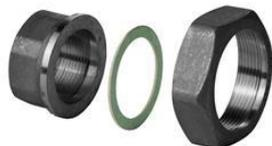
Filetage cylindrique selon ISO 228-1 côté vanne. Filetage conique extérieurement ou filetage cylindrique en interne selon ISO 7-1 côté tube. Chaque kit de montage ALG..3 se compose de 3 écrous borgnes, 3 écrous borgnes et 3 joints plats.
